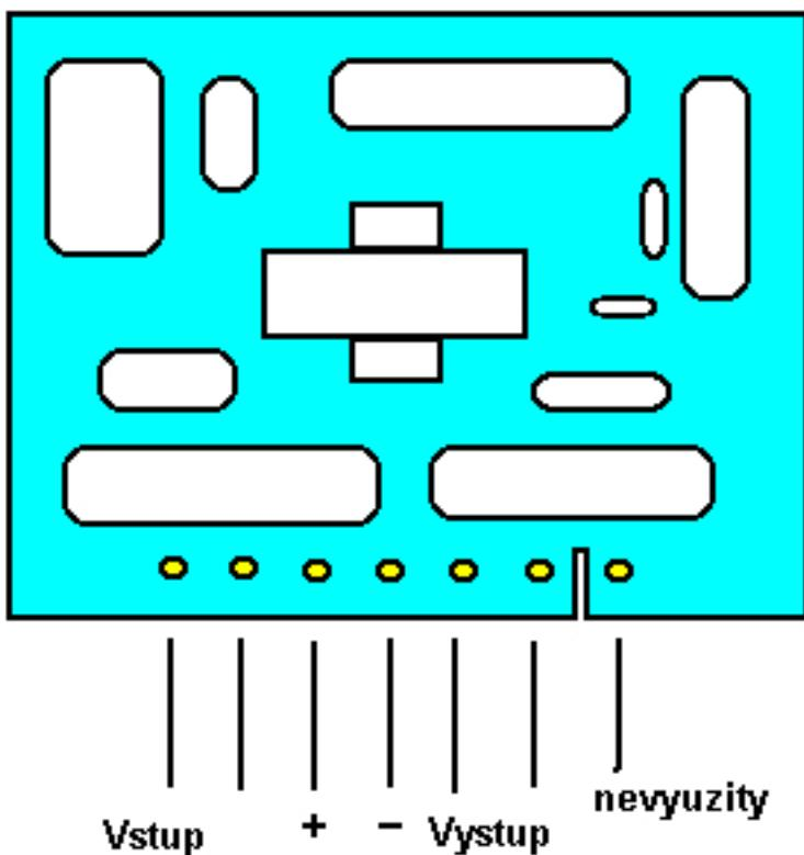
Zosilňovač má pri napätí 12V výkon okolo 4W. Na vývody "Vstup" pripojíme signál, ktorý chceme zosilniť, na vývody "Výstup" pripojíme reproduktor. A nakoniec na svorky + a - pripojíme napájacie napätie. Vývod označený ako "Nevyužity" je zem a nie je nijako využitý. zosilňovač je sice mono a nedosahuje kvality HI-FI ale na pokusné zapojenia úplne stačí. Ak si chcete zosilňovač postaviť sami, na ďalšom obrázku je doporučená schéma zapojenia (zdroj: katalóg).
